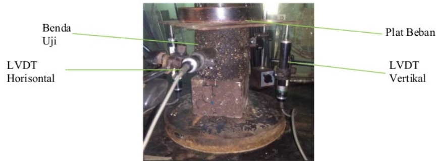
Gambar 4. Skema pengujian kuat tekan bebas
