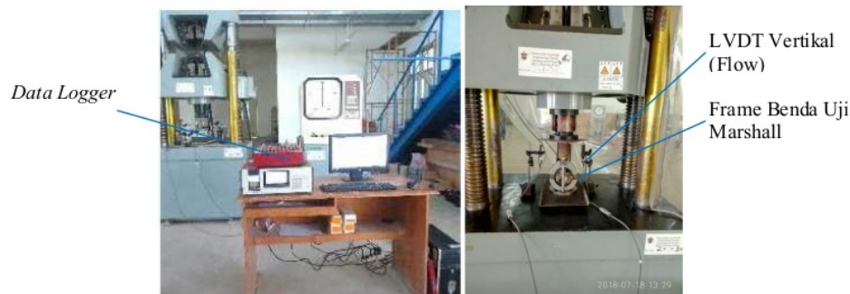
Gambar 3. Skema Pengujian Stabilitas Marshall dengan UTM
